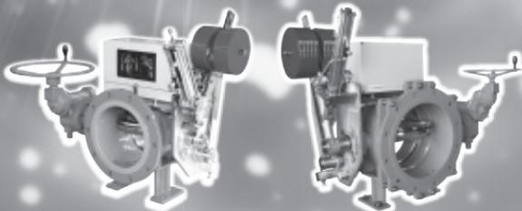
命の源である“水”を守るため、配水池や貯水タンクの流出管等に設置し、無電源環境下における、地震や管路事故の発生時でも、異常(地震・過流速)を検知し、確実に緊急遮断(閉止)します。
