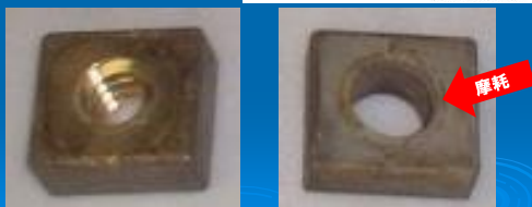
電動仕切弁: めねじこまの摩耗
